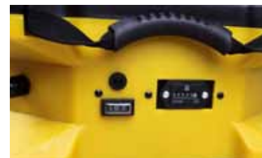
CDX 20 vezérlőpanel, üzemóraszámlálóval
